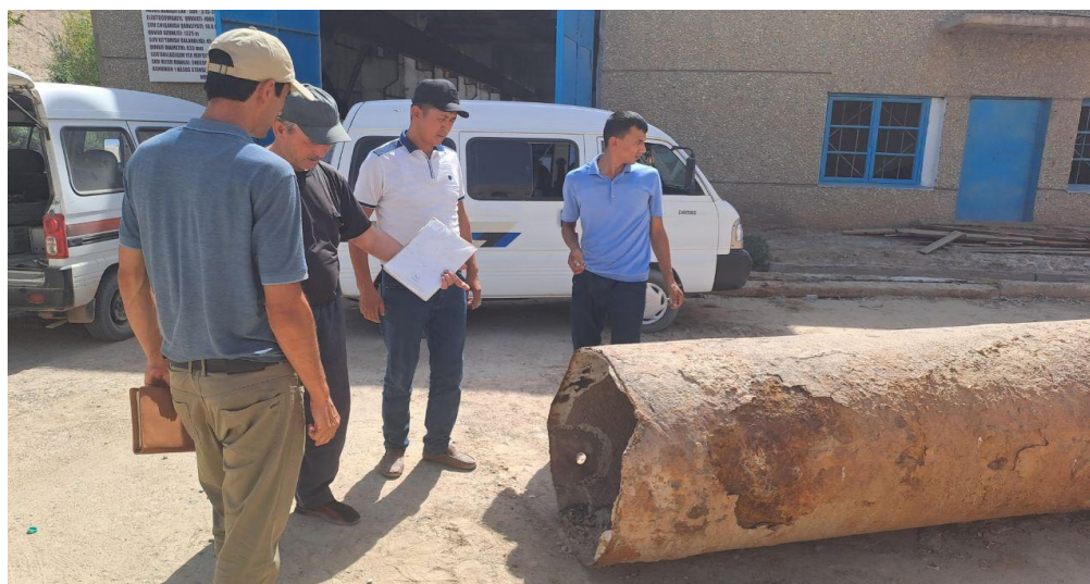
Рисунок 2. Текущее состояние насосных станций Сурханского бассейнового управления ирригационных систем и напорных трубопроводов насосной станции «Бандихон-1», принадлежащей энергетическому управлению.
